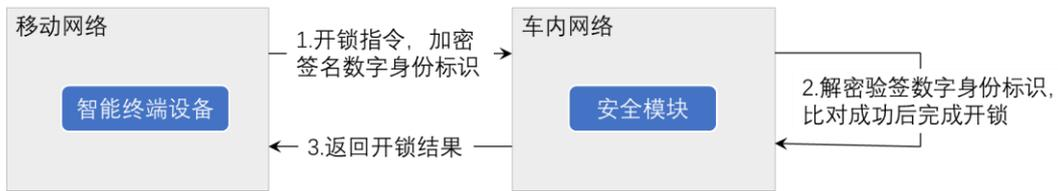
图 A. 4 车辆近距离开锁基本流程
